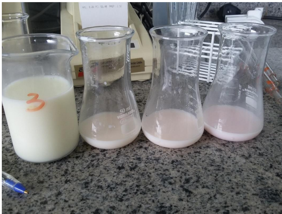
Figura 2. Ponto de virada da titulação com solução Dornic na análise de acidez.
