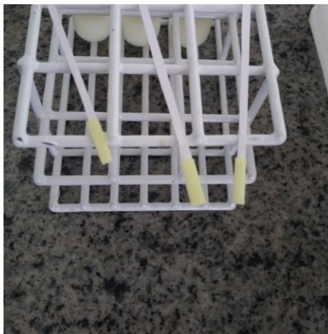
Figura 3. Método das tiras reativas para análise da enzima fosfatase alcalina.
