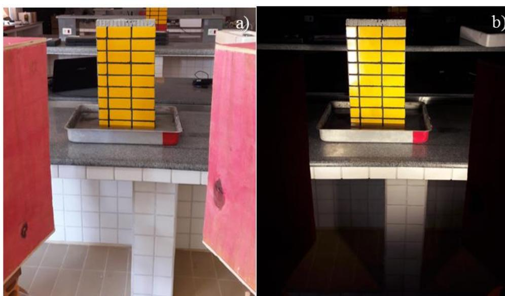
Figura 25 – Sistema de aquecimento da placa com revestimento cerâmico 50% de cada cor: a) Sistema de aquecimento com as lâmpadas desligadas; b) Sistema de aquecimento com as lâmpadas ligadas
