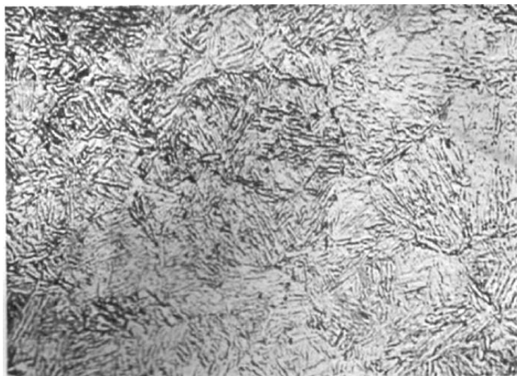
Figura 11 – Micrografia do aço com 0,5% de carbono temperado em água
