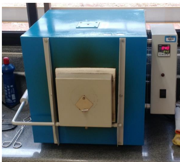
Figura 12 – Forno tipo Mufla com temperatura controlada
