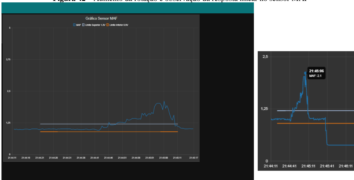
Figura 42 – Aumento da rotação e observação da resposta linear no sensor MAF
