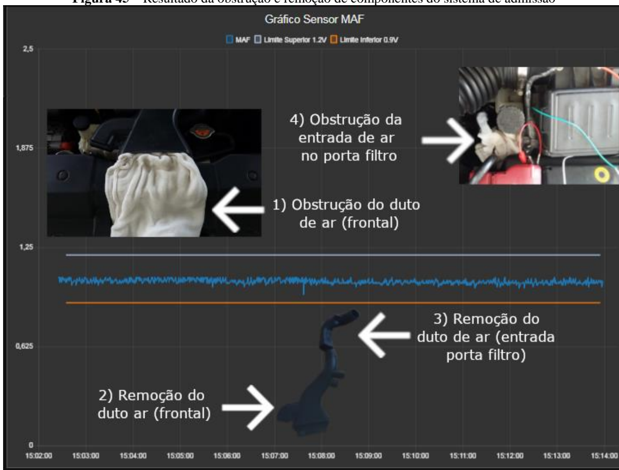
Figura 45 – Resultado da obstrução e remoção de componentes do sistema de admissão
