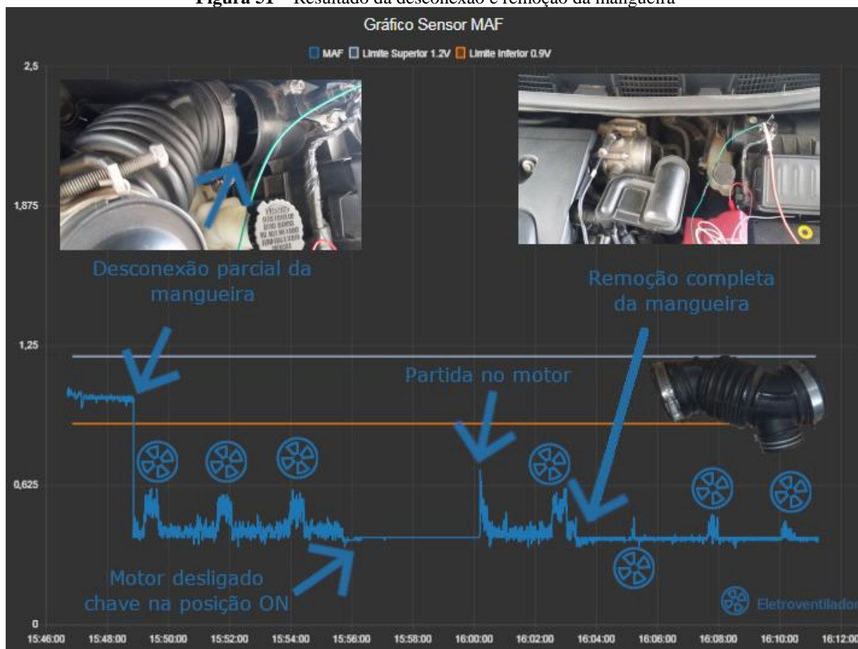
Figura 51 – Resultado da desconexão e remoção da mangueira
