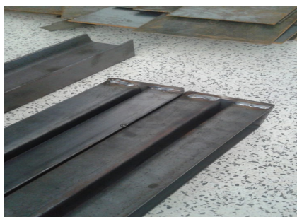
Figura 25 – Barras soldadas (a) Fonte: Autoria própria
