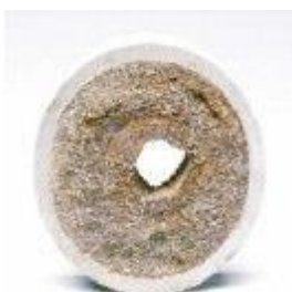
Figura 1: Linha bloqueada por deposição de parafina.
