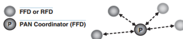
Figura 15: Exemplo de topologia estrela
