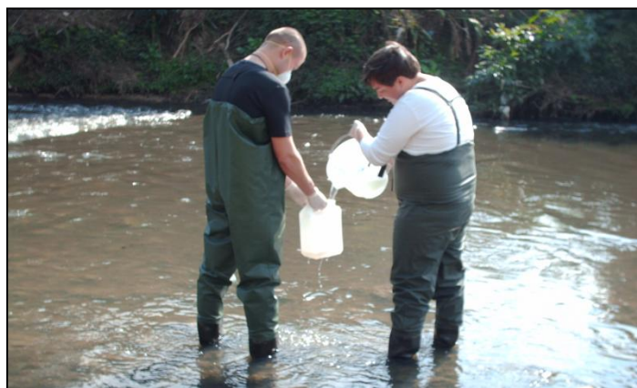
FIGURA 4: Coleta de Amostras de Água na Sub-bacia do Rio Barigüi (abordagem mãos-limpas – mãos sujas).
