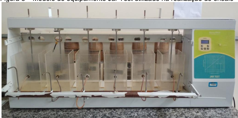
Figura 8 – Modelo do equipamento Jar Test utilizado na realização do ensaio
