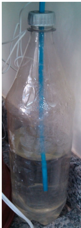
Figura 10 - Técnica utilizada para observar a produção de gás no reator UASB
