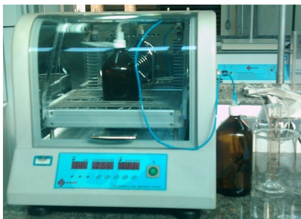
Figura 14–Aparato para o ensaio da atividade metanogênica específica do lodo.
