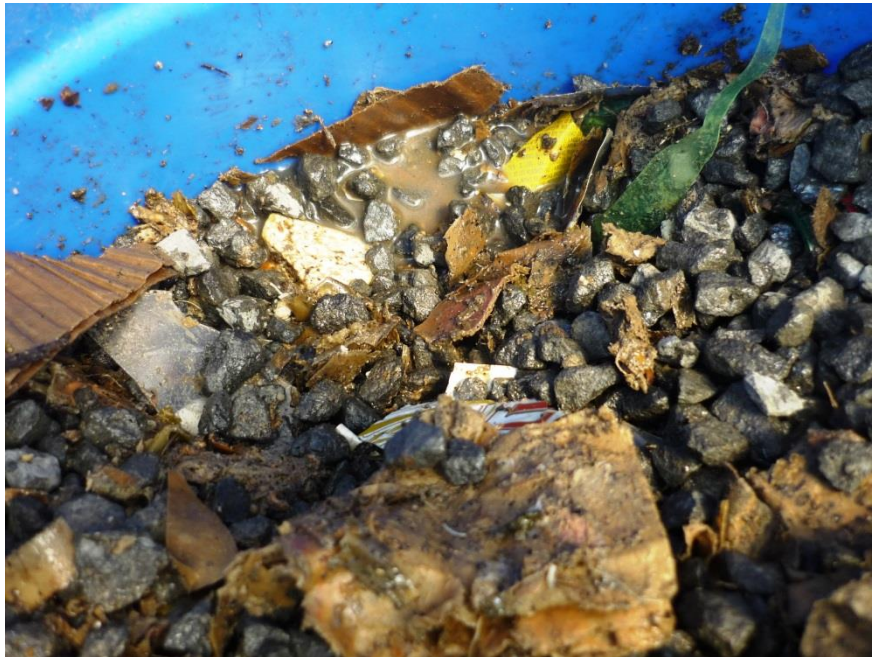
Figura 16 - Acúmulo de lixiviado na massa de resíduos do reator 1
