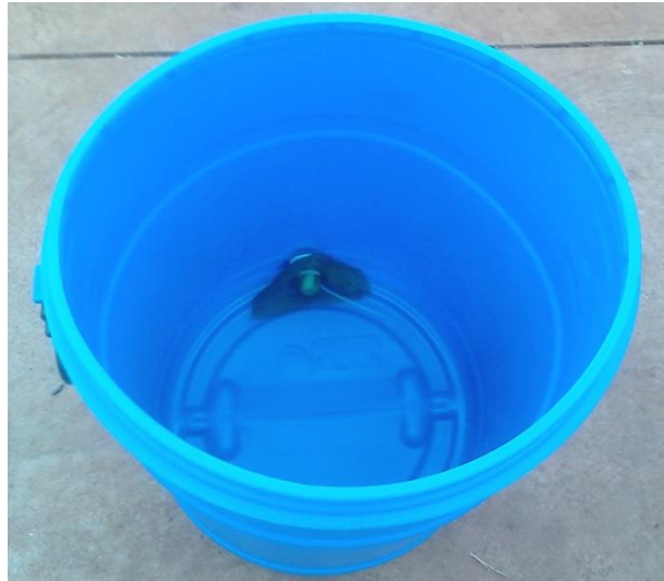
Figura 4 - Tela colocada da entrada interna da torneira para impedir sua obstrução.
