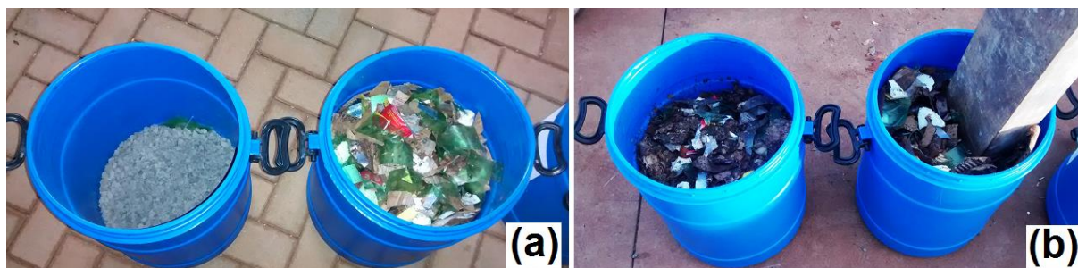
Figura 10 - Processo de preenchimento dos reatores em (a) e compactação dos resíduos em (b)
