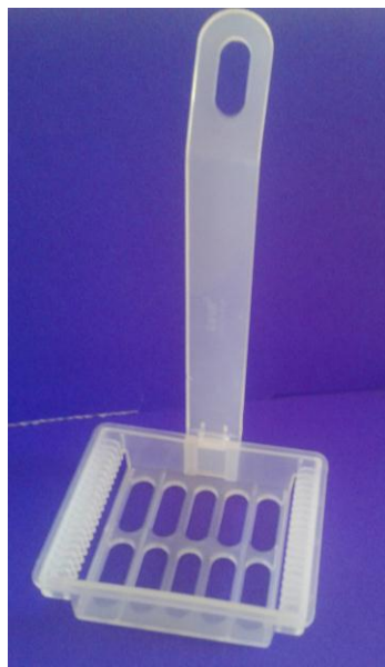
Figura 7 - Suporte de plástico para acomodação das lâminas de vidro no interior dos reatores.
