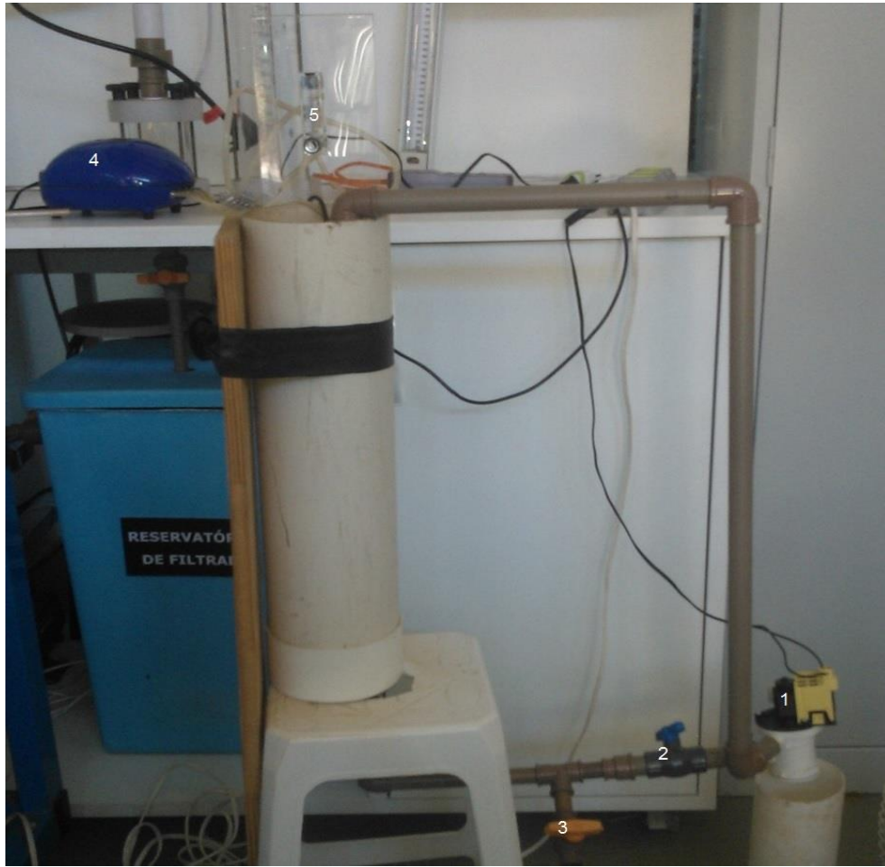
Figura 3 – Fotografia da Vista Lateral do BAS. (1) Bomba para recirculação do efluente; (2) Registro para regular a vazão do efluente; (3) Registro para retirada de amostras; (4) Aerador; (5) Rotâmetro; Fonte: próprio autor.
