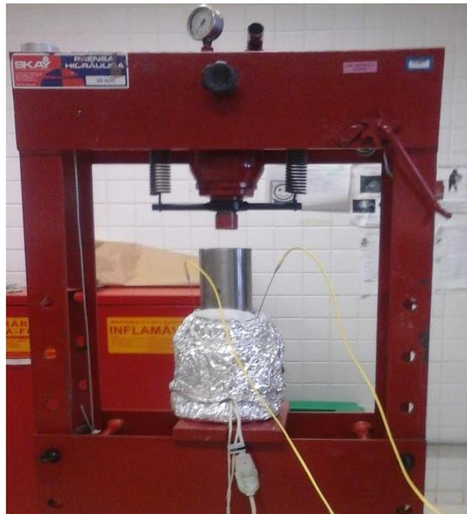
**Figura 19 - Montagem do sistema de compactação**
