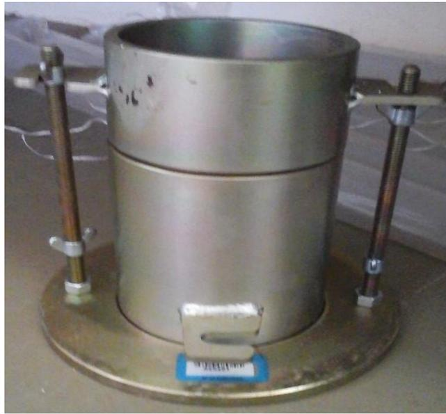
**Figura 18- Molde utilizado no ensaio de compactação**
