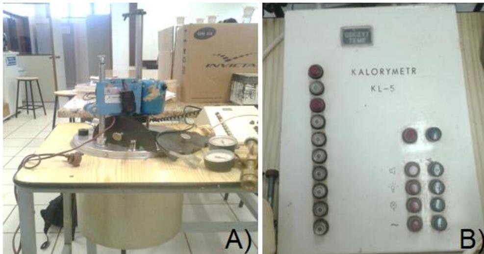
**Figura 12- Calorímetro Precyzja tipo KL-5 antes das modificações, à esquerda (a); mesa de controle à direita (b)
