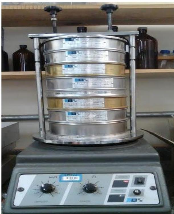
**Figura 11- Peneiras utilizadas no ensaio granulométrico**
