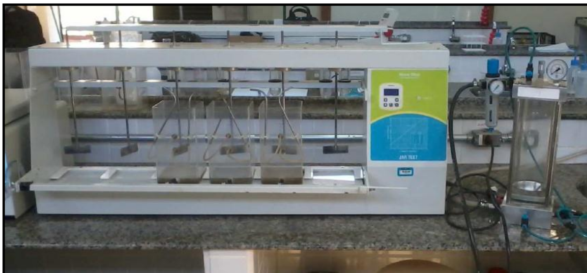
Figura 5 - Equipamento utilizado no ensaio de coagulação, floculação e flotação (Floteste e câmara de pressurização) Fonte: Casagrande (2014).
