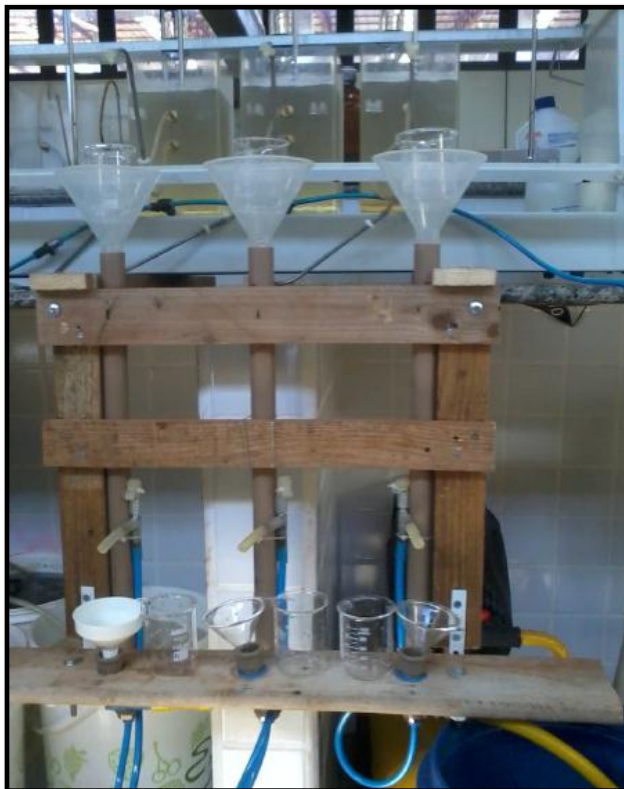
Figura 6 - Colunas de filtração utilizadas no ensaio Fonte: Casagrande (2014).
