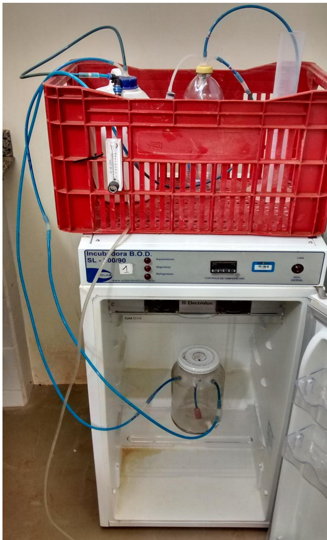
Figura 8: Foto do sistema respirométrico. Fonte: Autoria própria.
