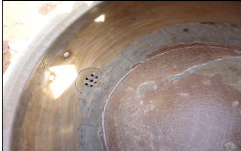
Figura 10 – Foto mostrando chaleira de uso diário com incrustações carbonáticas no seu interior.
