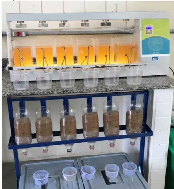
Figura 7: Aparato experimental completo, Jar-Test e filtros.
