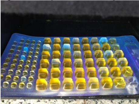
Figura 9: Plaqueta Quanti-Tray/2000 na luz ultravioleta depois de 24 horas em estufa.
