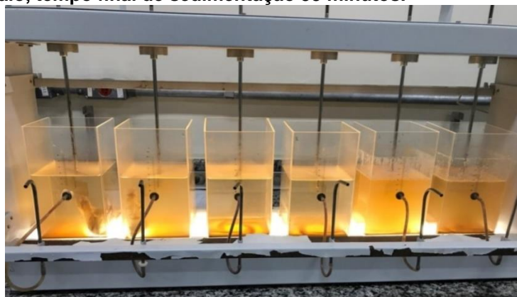
Figura 16: Primeiro ensaio, tempo final de sedimentação 33 minutos.
