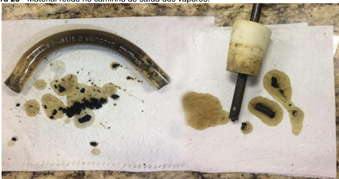
Figura 23 - Material retido no caminho de saída dos vapores.
