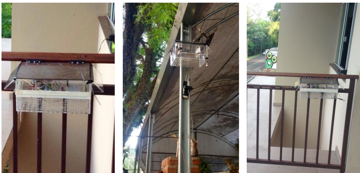
Figura 13: Plataformas instaladas em campo nos empreendimentos parceiros. (a) Sistema na carcaça em acrílico; (b) Zerão; (c) Rua Humaitá.
