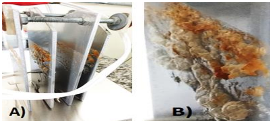
Figura 28 - Eletrodos após 80 minutos de eletrocoagulação. A) Acúmulo de sólidos nos eletrodos. B) Aspecto do material acumulado.
