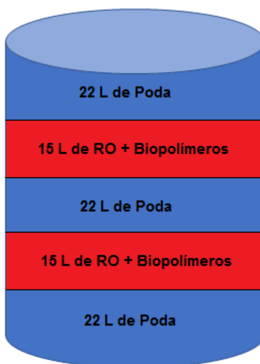
Figura 7 - Esquemática das camadas das bombonas
