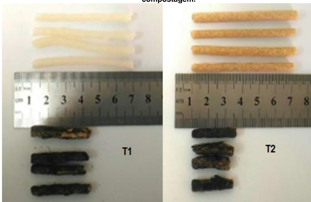
Figura 21 - Registros Fotográficos dos biopolímeros inicial e ao final do processo da compostagem.
