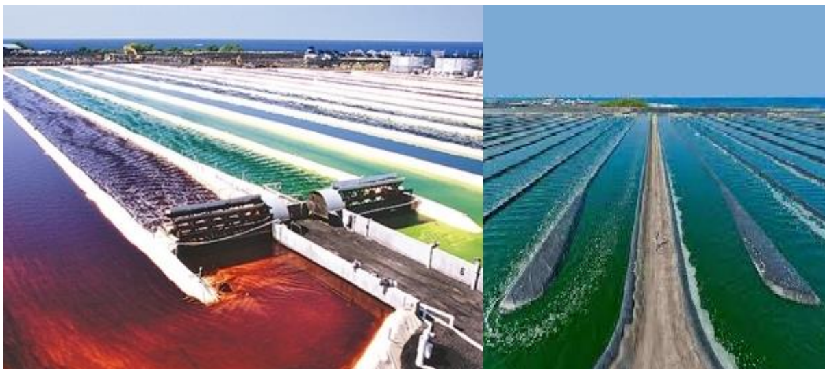
Figura 2-Exemplos de sistemas abertos de cultivo de microalgas. Fonte: Cyanotech Corporation
