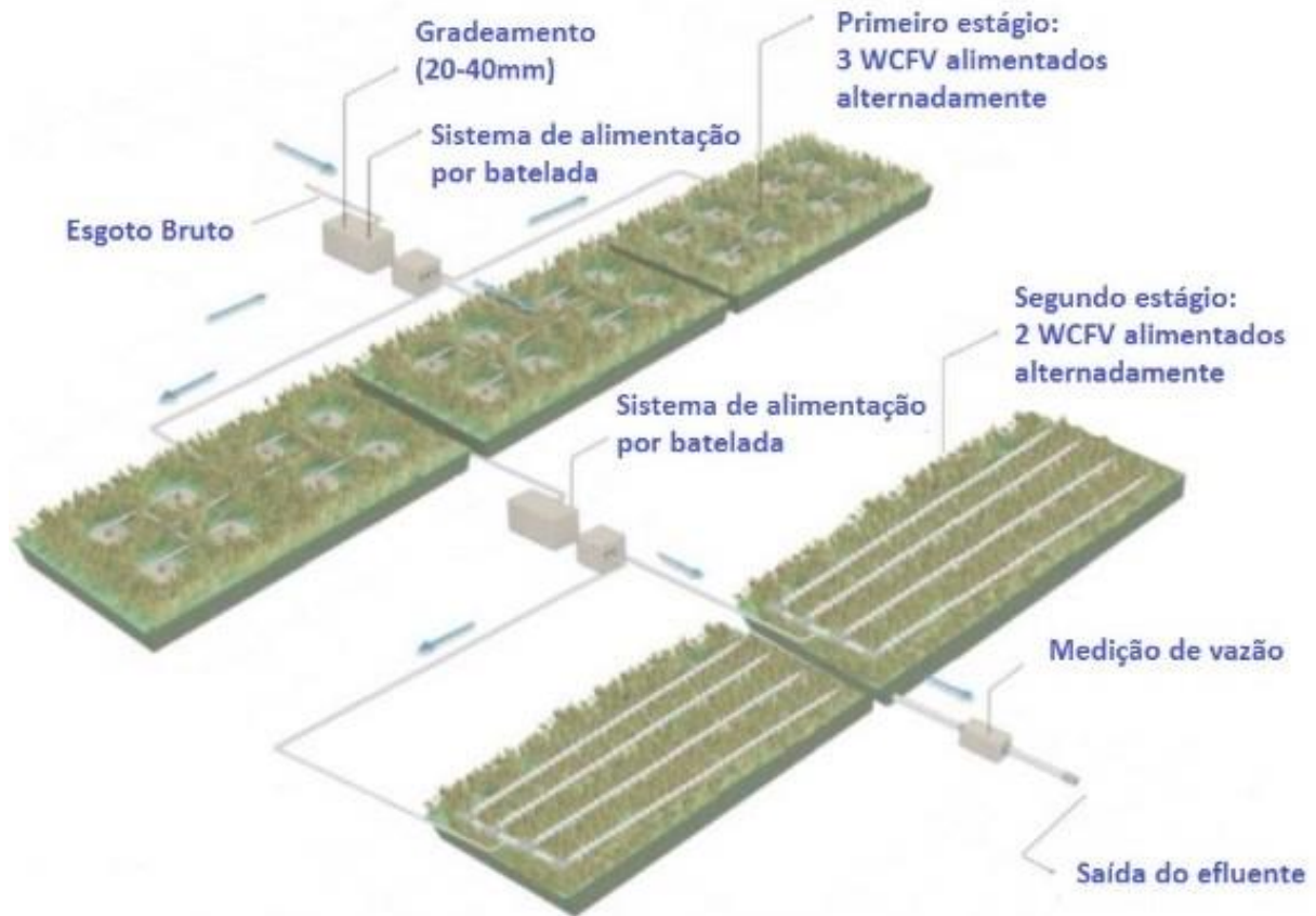
Figura 5 - Representação esquemática de um wetland construído em modelo Francês
