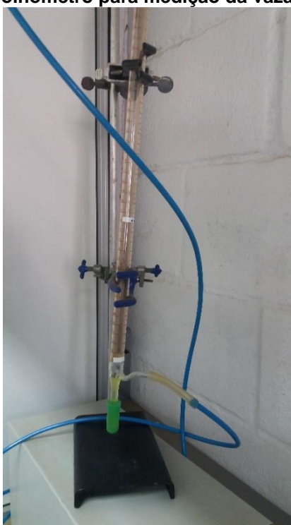
Figura 23 – Bolhometro para medição da vazão volumétrica
