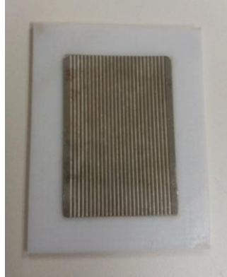
Figura 11 – Placa sobre a estrutura para aplicação do material suporte
