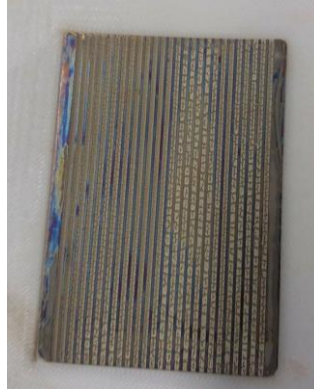
Figura 13 – Placa após a calcinação a 500°C durante 2h em mufla
