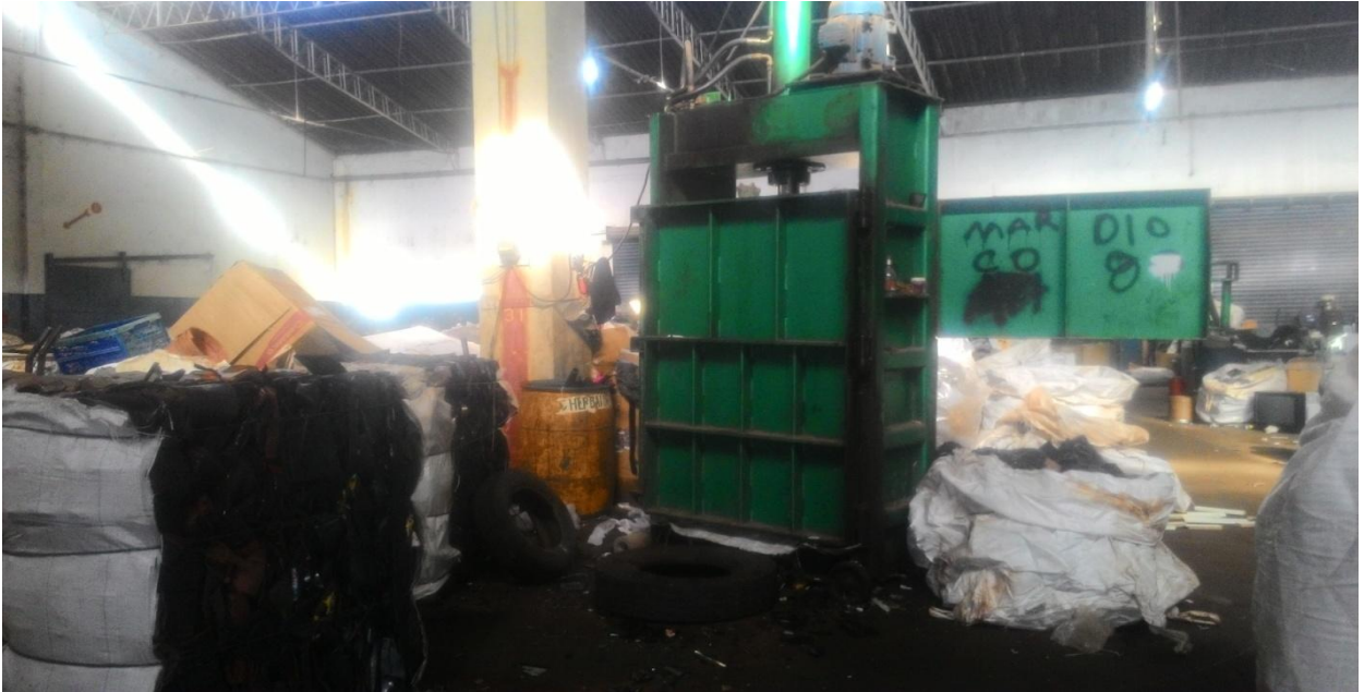
Figura 9 – Foto da prensa mecânica para a prensagem dos materiais e formação dos fardos localizada na área central do galpão da Cooperita.
