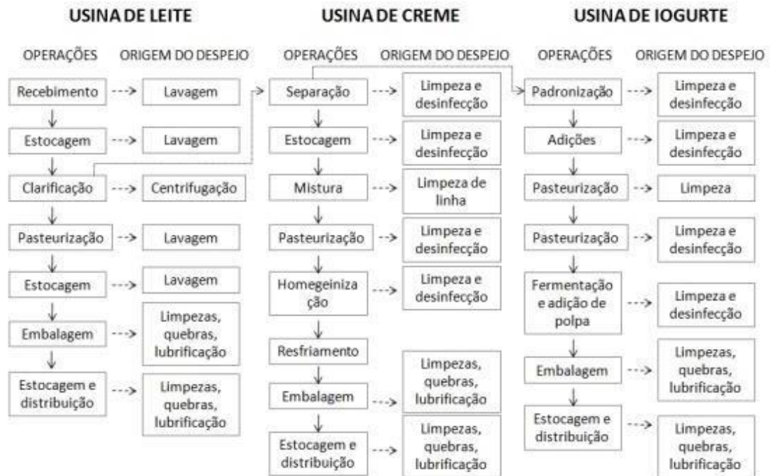
Figura 2: Principais fontes de geração de efluentes nas usinas de leite, creme e iogurte.
