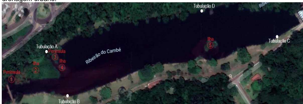
Figura 22: Localização das ilhas/penínsulas de sedimentos e pontos de lançamento do sistema de drenagem urbano.
