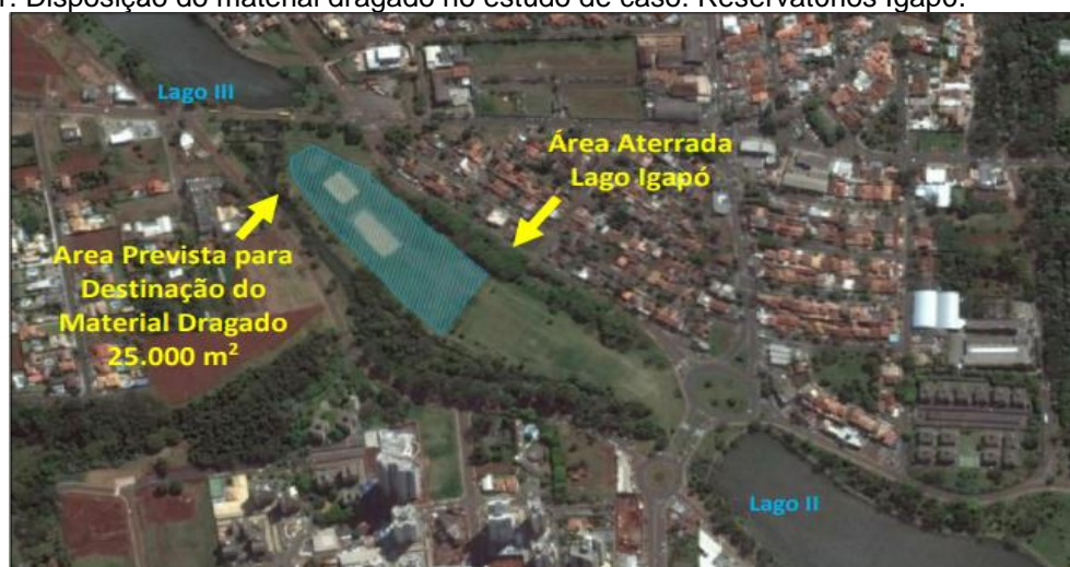
Figura 11: Disposição do material dragado no estudo de caso: Reservatórios Igapó.
