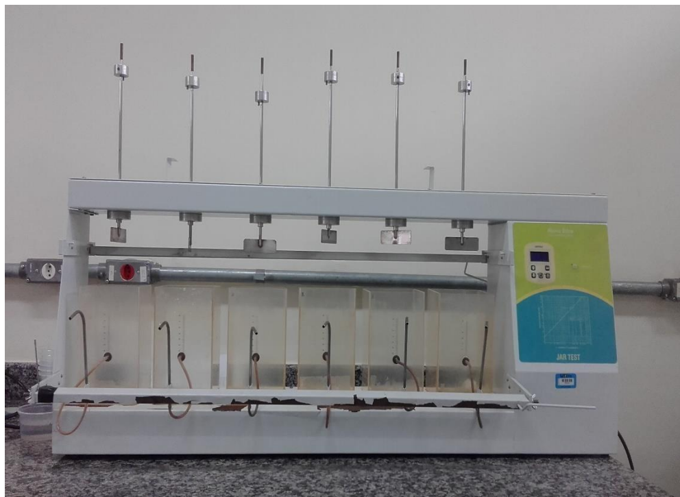
Figura 3 - Equipamento Jar-Test utilizado neste experimento
