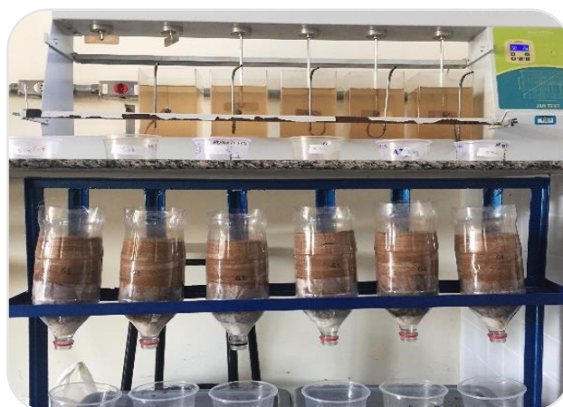
Figura 4 - Filtros de areia utilizados
