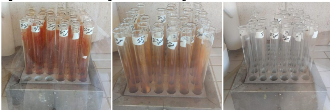
Figura 10 – Processo de digestão em bloco digestor.
