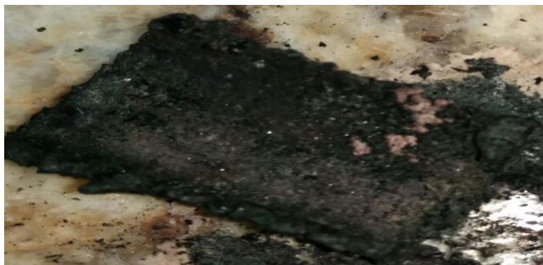
Figura 36 - Tecido de algodão cru tratado com polianilina pelo 2º método por 6 minutos Fonte: Autoria própria.
