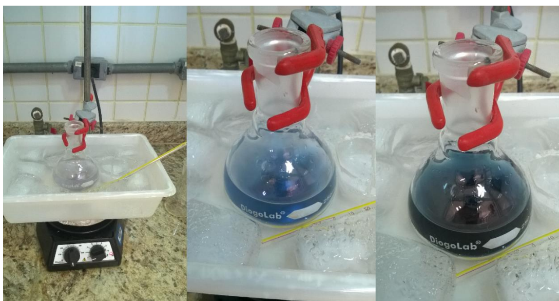
Figura 26 - Variação de coloração do meio reacional com a adição dos precursores e agitação Fonte: Autoria própria.
