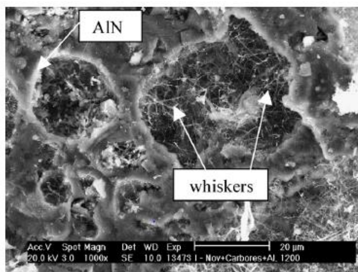
Figura 20 - Whiskers das fases Al_4C_3 e Al_2OC .
