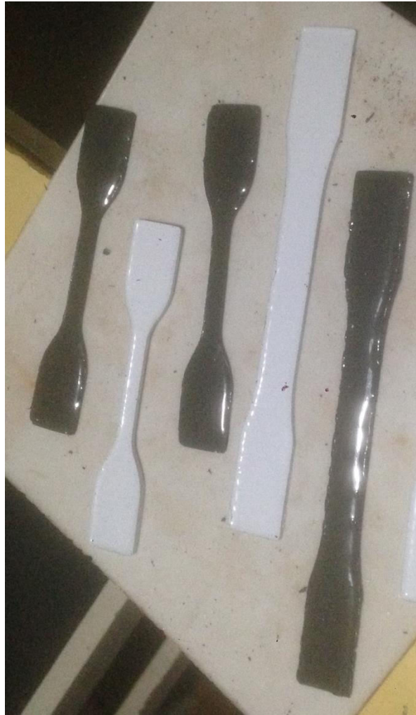
Figura 16 – Corpos-de-prova do tipo I e IV segundo ASTM D638-02a.
