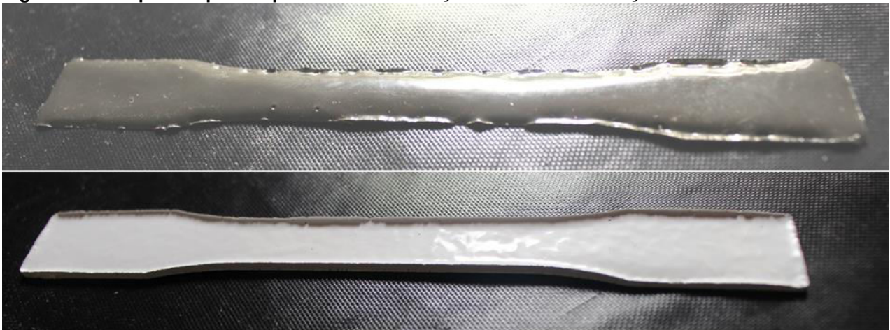
Figura 21 – Corpos-de-prova apresentando distorções devido às condições de cura.
