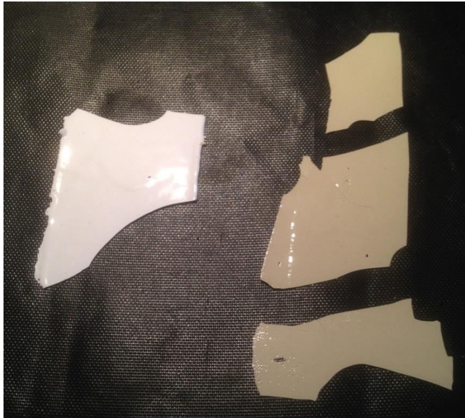
Figura 20 – Filmes após tentativa de introdução de pré-trincas.
