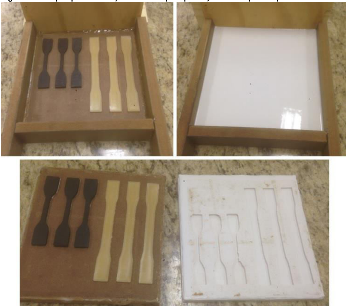
Figura 14 – Etapas para confecção do molde para produção dos corpos-de-prova.
