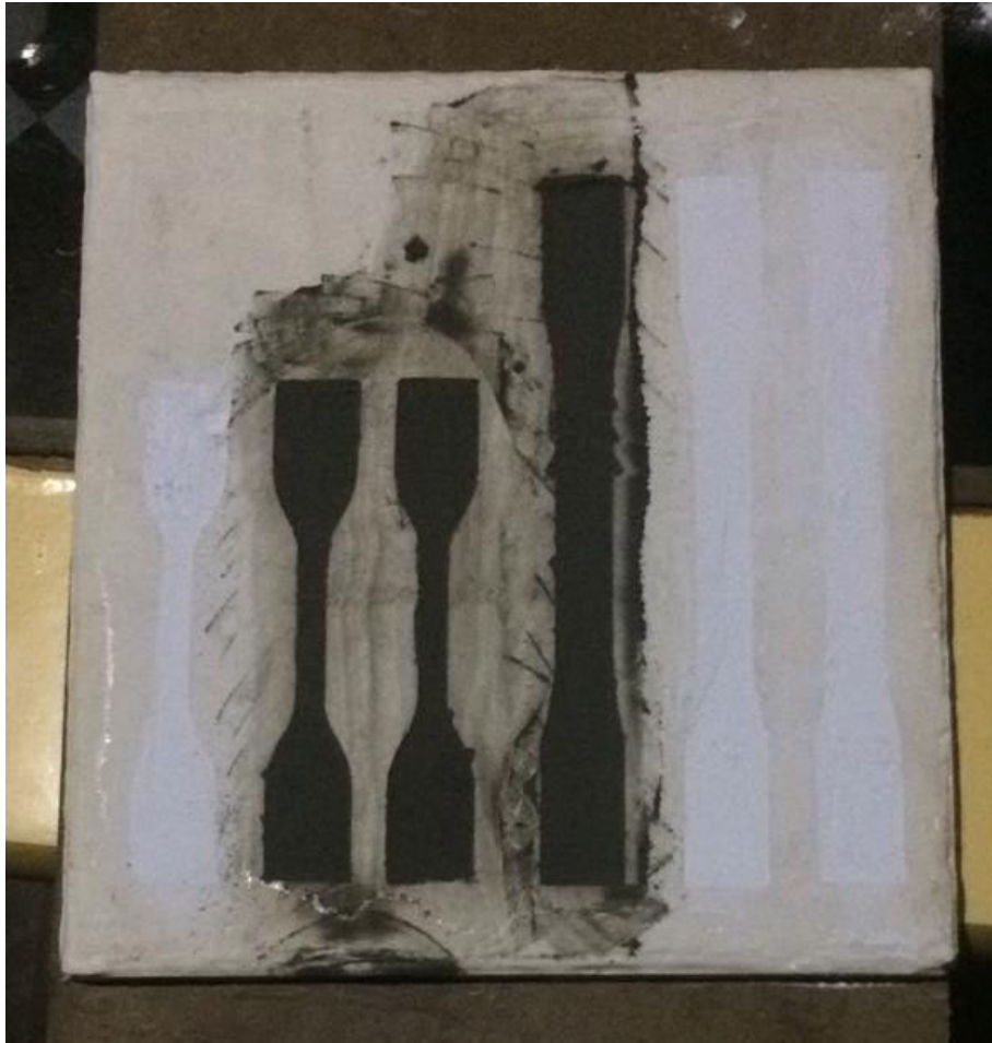
Figura 15 – Acomodação da resina em pó nas cavidades do molde de silicone.
