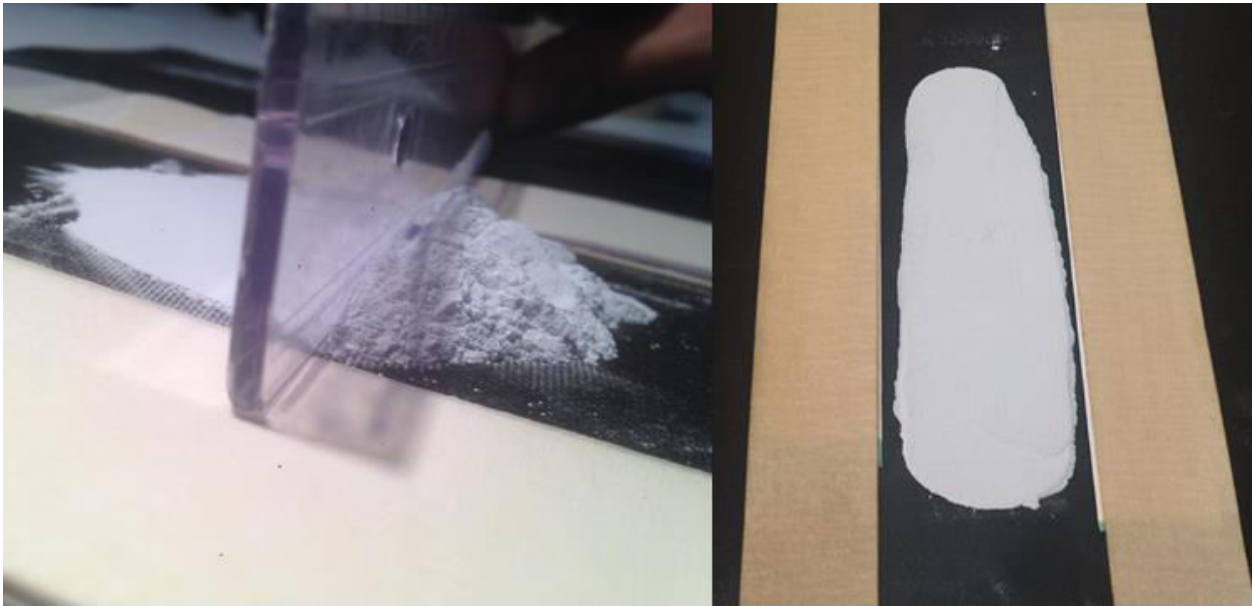
Figura 12 – Preparação e formação do filme a partir da resina em pó.
