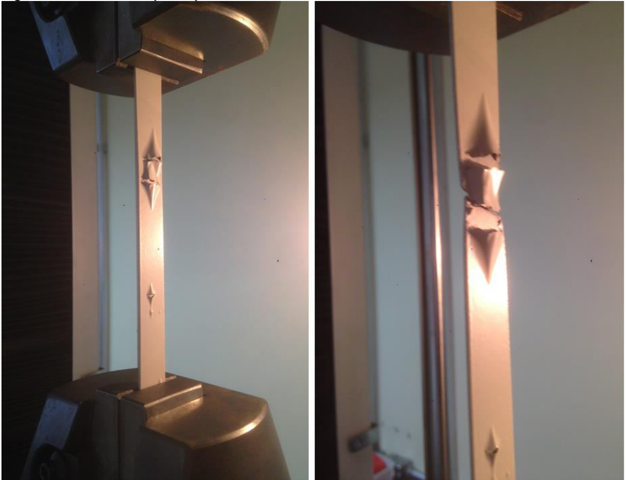
Figura 24 – Primeiro corpo-de-prova ensaiado revestido com tinta híbrida.
