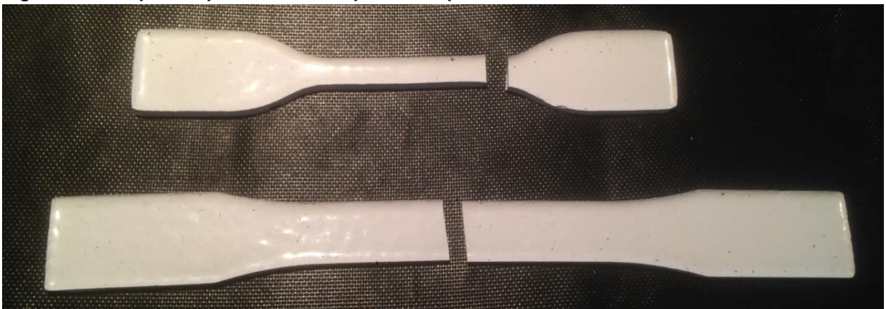
Figura 23 – Corpos-de-prova a base de poliéster após tentativa de manuseio.
