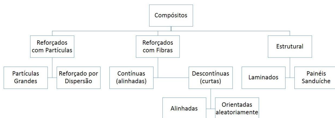
Figura 8 – Esquema de classificação simples de compósitos
