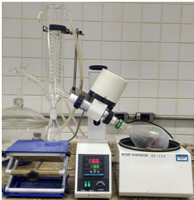
Figura 17 - EPS Botriosferana no rotoevaporador com temperatura máxima de 80 °C para remoção do excesso de água.
