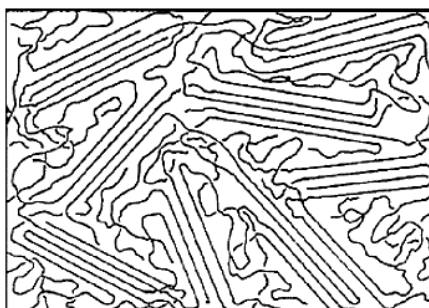
Figura 4 - Estrutura heterogênea semicristalina da PANI.
