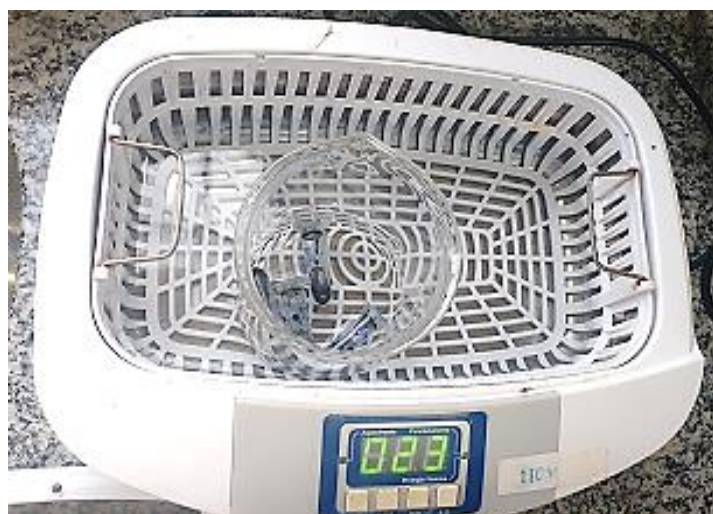
Figura 18 - Amostras do compósito (PB) em banho ultrassônico.
