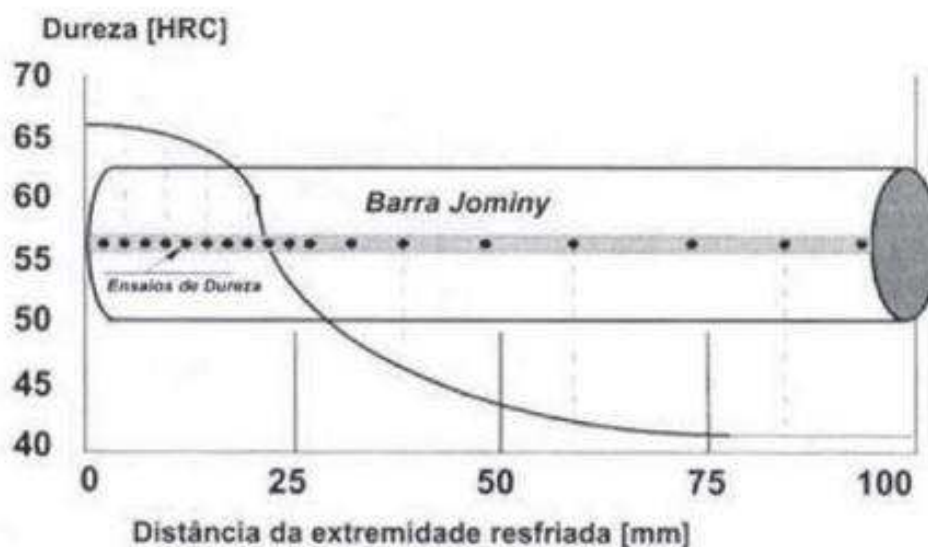
Figura 11 - Exemplo de uma curva de endurecibilidade, contendo um corpo de prova Fonte - (XAVIER, CARLOS ROBERTO, 2011)
