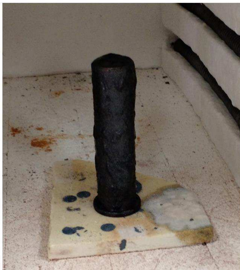
Figura 22 - Amostra com a mistura álcool/grafite em sua superfície Fonte – Autoria Própria
