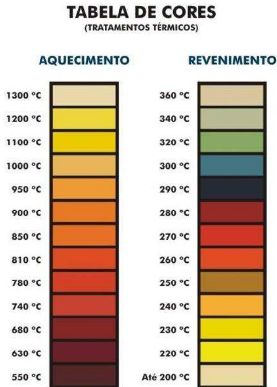
Figura 36 - Cores dos metais relacionado a temperatura Fonte - ("Tecnohard", 2011)
