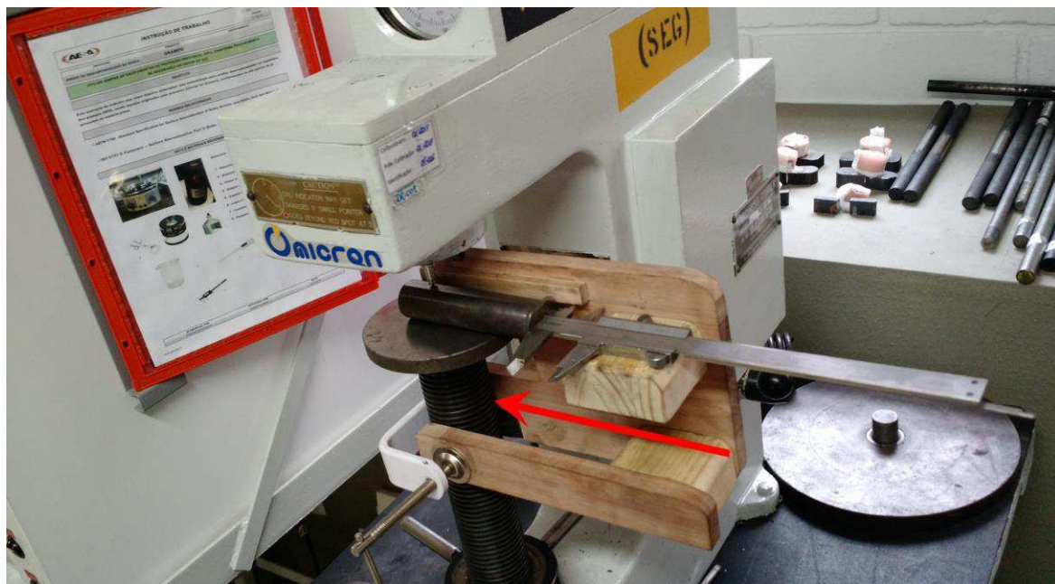
Figura 26 – Foto demonstrando como o suporte funciona. A seta vermelha revela o movimento realizado para mover idealmente a amostra. Fonte – Autoria própria.
