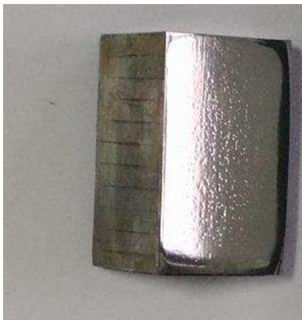
Figura 31 - Amostra após ser lixada, traçada e polida. Pode-se notar a presença de carbonetos na superfície polida
