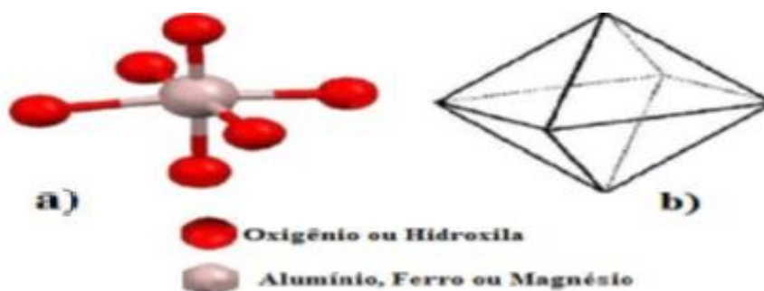
Figura 2 - a) geometria octaédrica para cátions \text{Al}^{3+} , \text{Fe}^{3+} ou \text{Mg}^{2+} , e b) representação da figura geométrica do octaedro
