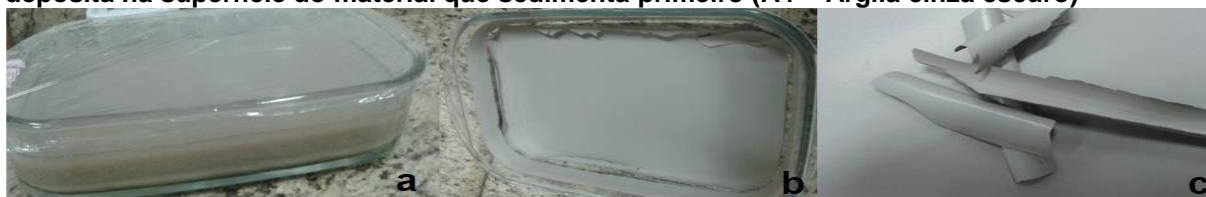
Figura 34 – (a) Suspensão inicial. (b) Suspensão seca. (c) Partes de um material distinto que se deposita na superfície do material que sedimenta primeiro (A4 – Argila cinza escuro)
