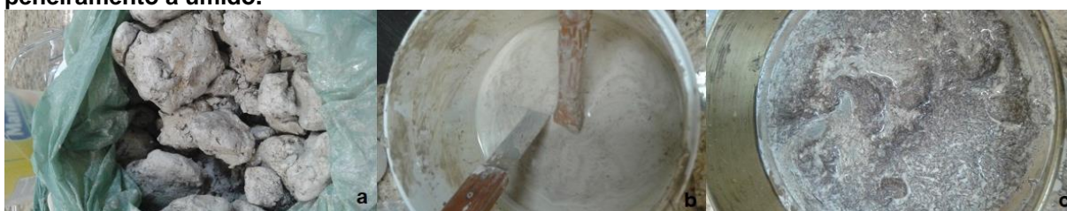
Figura 33 – (a) amostra in natura após ser retirada do solo. (b) Amostra em suspensão. (c) peneiramento a úmido.
