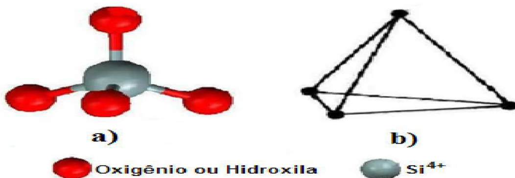
Figura 1 - Geometria tetraédrica para cátions \text{Si}^{4+} , a) representação por traços (ligações covalentes) e bolas (átomos); b) representação da figura geométrica do tetraedro
