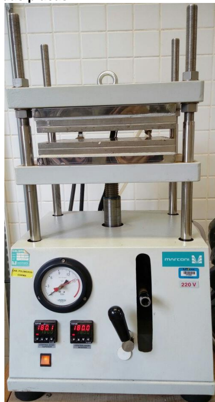
Figura 24 – Prensa hidráulica Marconi utilizada para produção das placas.
