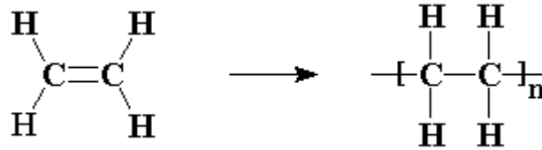
Figura 13 – Esquema simplificado da polimerização por adição do polietileno
