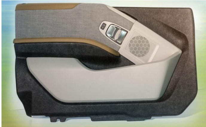
Figura 1 – Imagem da parte interna da porta de um BMW i3 revestido com fibra natural.
