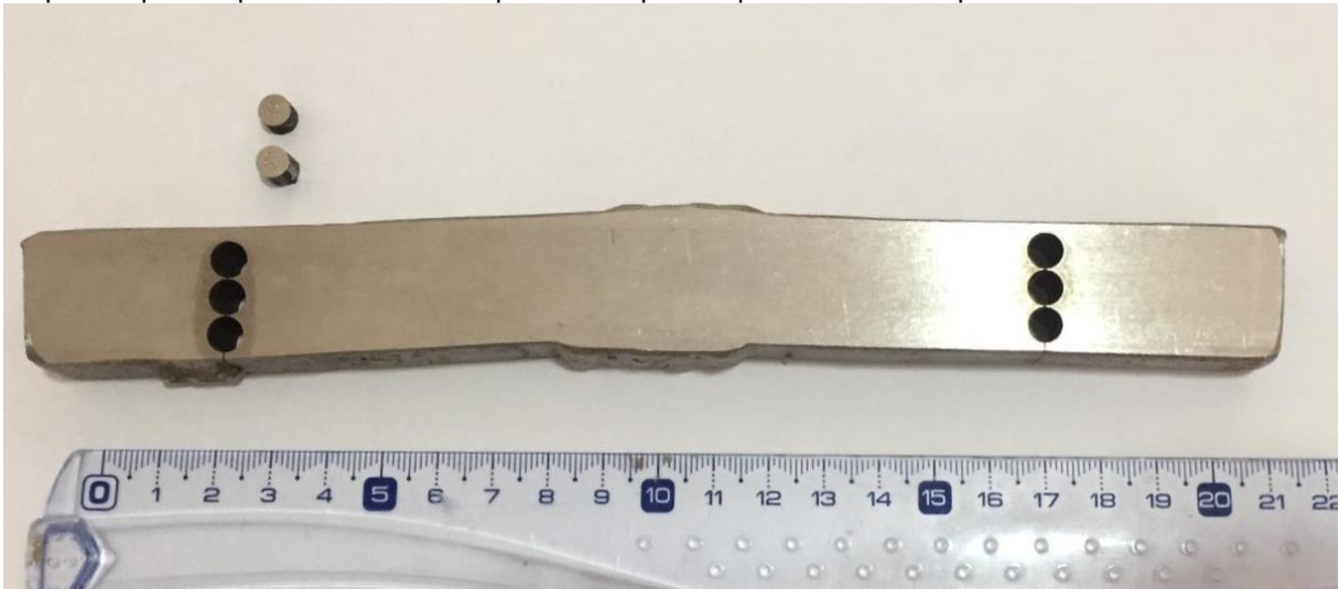
Figura 17 – Fatia da junta soldada de aço inoxidável superduplex a partir da qual foram retirados os corpos de provas para o ensaio de impacto e corpos de prova cilíndricos para análise microestrutural
