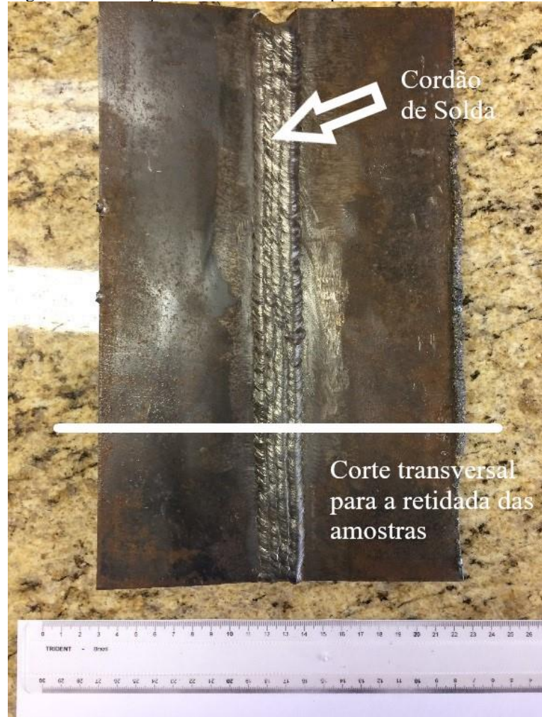
Figura 11 - Ilustração do corte transversal para a retirada das amostras.
