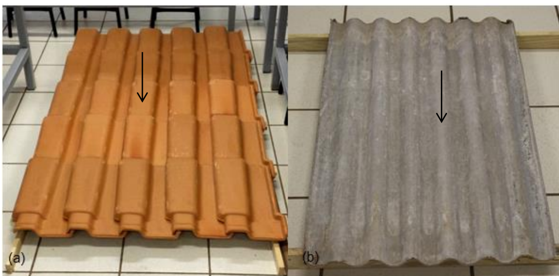
Figura 5 – Ilustração dos panos de telhas cerâmicas (a) e telha de fibrocimento (b). As setas indicam as regiões das telhas onde foram impostos os impactos com esfera de aço.
