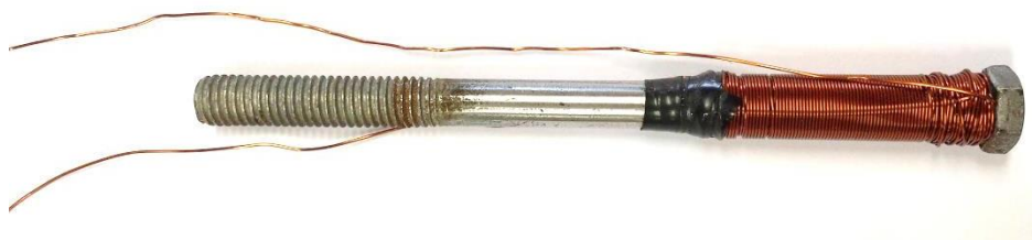
Figura 3 – Eletro-ímã utilizado no ensaio NBR15575 - Anexo C.
