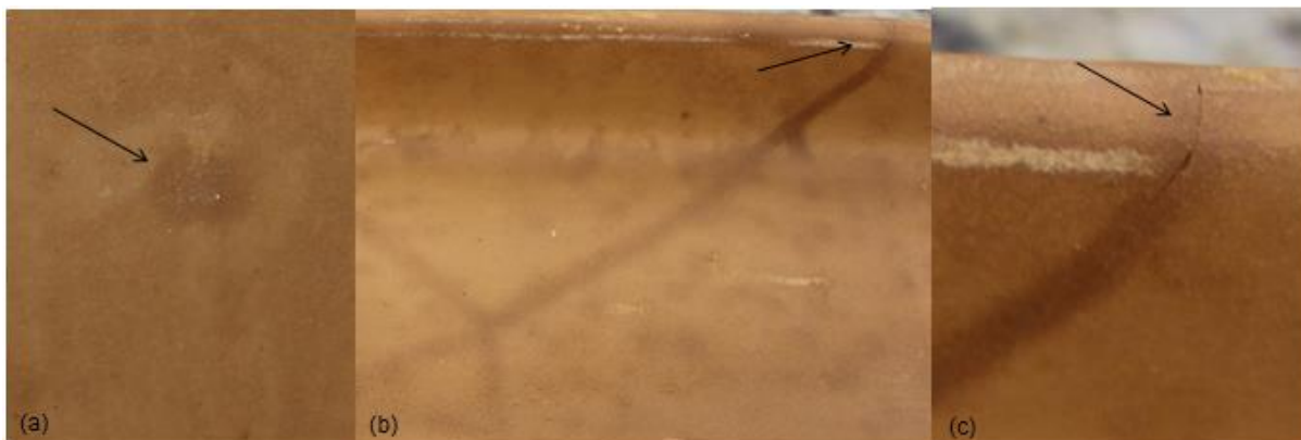
Figura 19 – (a) Marca superficial após impacto de esfera de aço em telha cerâmica a 3,0 metros com ampliação de aproximadamente 2x; (b) Nucleação de defeitos na face posterior da telha ao ponto de impacto após imersão em água propagando-se no sentido indicado pela seta e surgimento de trinca aparente com ampliação de aproximadamente 2x; (c) Ampliação da trinca de aproximadamente 4x.
