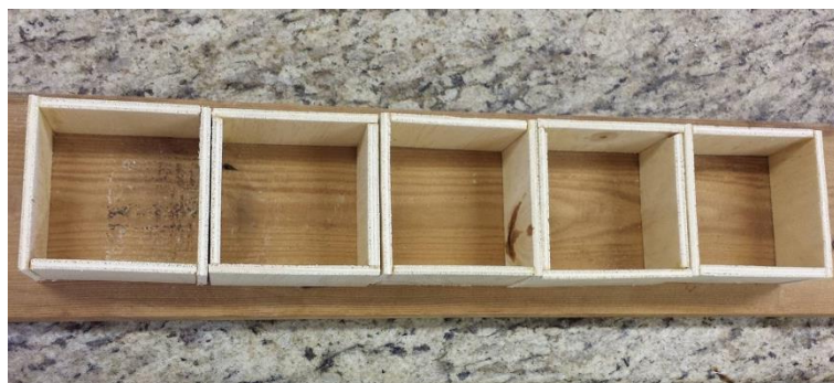
Figura 10 – Ilustração dos moldes de madeira utilizados na preparação dos blocos de concreto.
