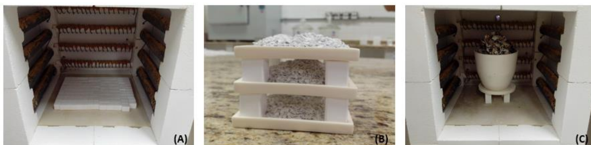
Figura 7 - Mobília utilizada na calcinação das cascas: (A) Blocos de zircônia, (B) Cadinho de alumina de base quadrada e (C) Cadinho de alumina em formato cônico.
