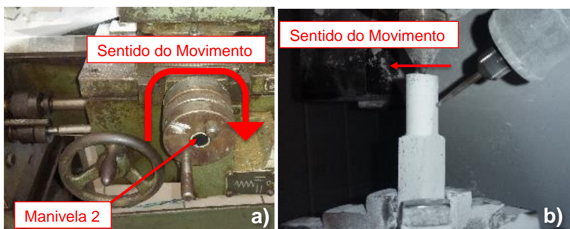
Figura 12 – Primeira e Segunda fases das usinagens. a) Posição da Manivela 2; b) Sentido da fresa. Fonte: Autorial Própria
