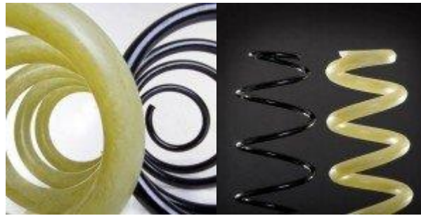
Figura 11 - Mola helicoidal produzida com material compósito Fonte: Gilini Júnior (2012)
