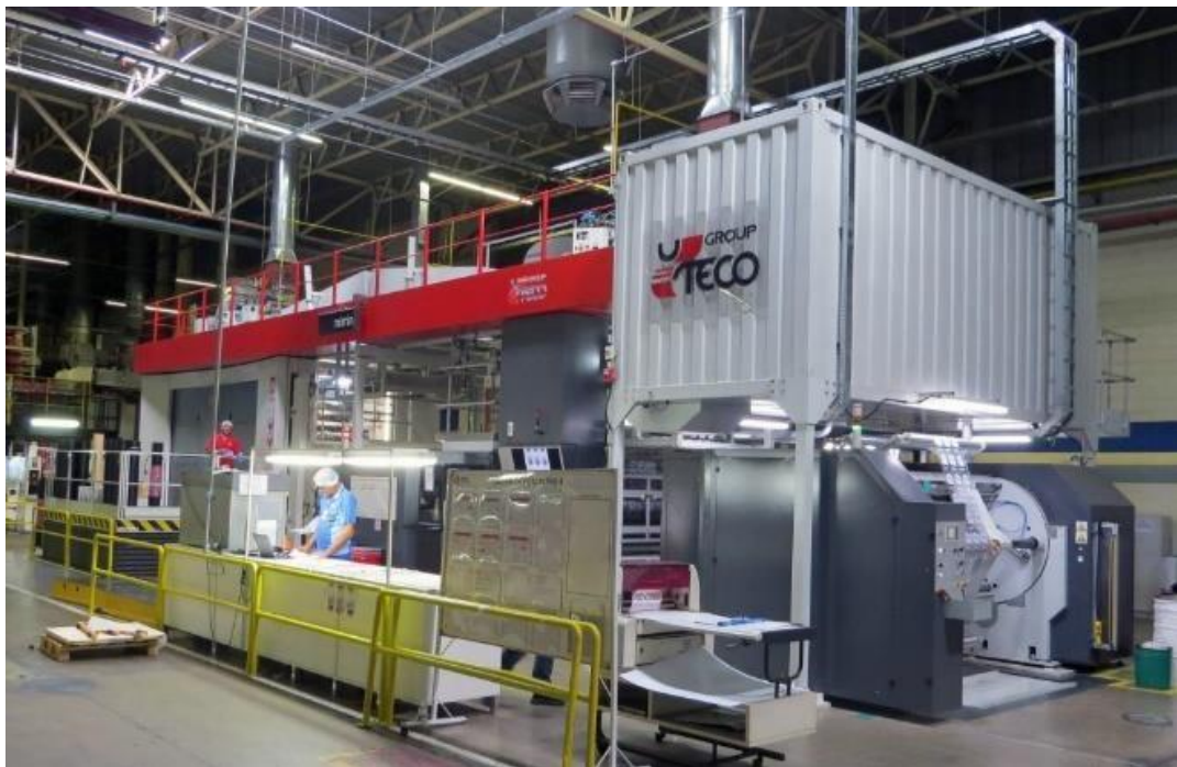
Figura 2 – Impressora flexográfica de 10 cores do Estudo de Caso.
