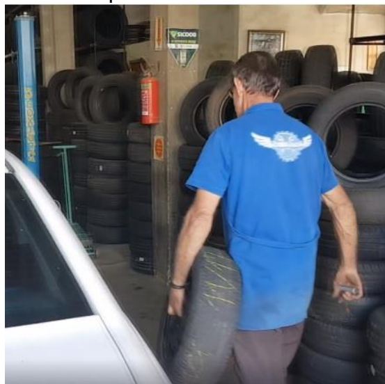
Figura 23 - Transporte da roda até banheira de água
