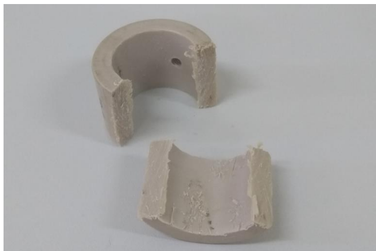
Figura 3.3 – Corpo de prova de PEEK seccionado para caracterizações após ensaio.
