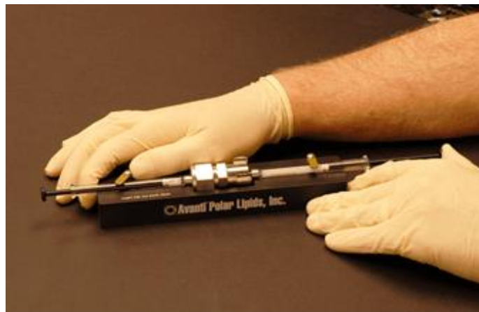
Figura 5 - A) Componentes que compõem o mini extrusor e B) Imagem de um mini-extrusor Fonte: Cabeça (2009).
