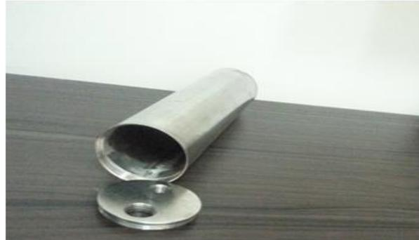
Figura 4: Sistema de conexão reator- tubo de gás nitrogênio.
