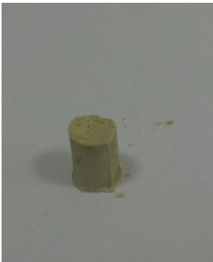
Figura 21: Corpo de prova para análise de resistência a compressão
