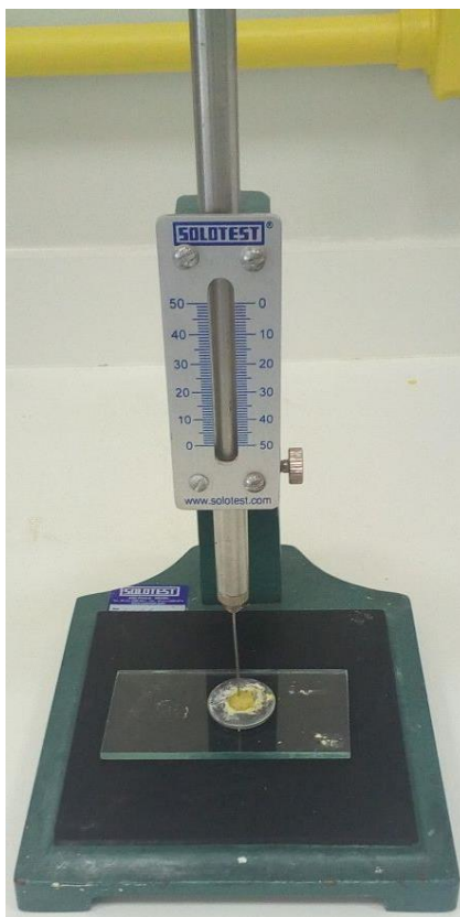
Figura 17: Agulha de Vicat + disco com amostra e análise de tempo de presa
